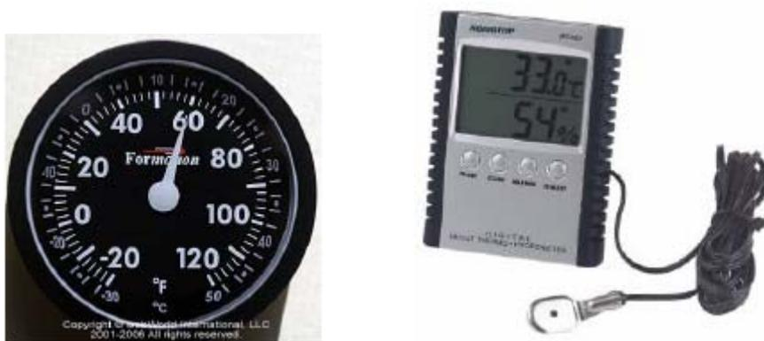
Figura 4.6 - Representação analógica e digital de uma temperatura
